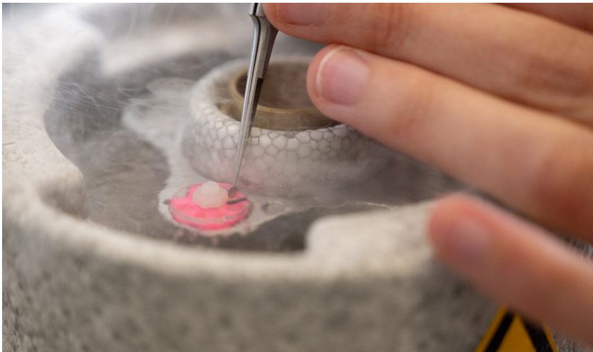
Vorbereitungen eines sehr kleinen Gitters für das Cryo-Elektronenmikroskop.
